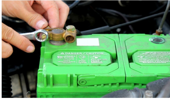
جنریٹر/آلٹرنیٹر کو گاڑی سے علیحدہ کرنے کا طریقہ کار
