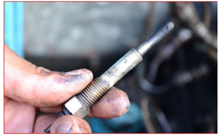
3- گلوپلگ الیکٹرک وڈ پر موجود کاربن اچھی طرح صاف کر کے انٹی رسٹ سپرے کریں۔
